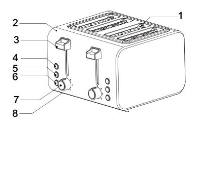
1 **Brotschlitze** Bread slots 2 Gehäuse Housing 3 Toasthebel Toast lever 4 Auftauen mit Kontrollampe Defrosting with control lamp 5 Erwärmen mit Kontrollampe Heating with control lamp 6 Stopptaste für alle 3 Funtkionene. Mit Kontrolllampe für Toastfunktion Stop button for all 3 funtions. With control lamp for toasting function 7 Drehregler für Bräunungsgrad Rotary browning control 8 Gummifuß Rubber foot
