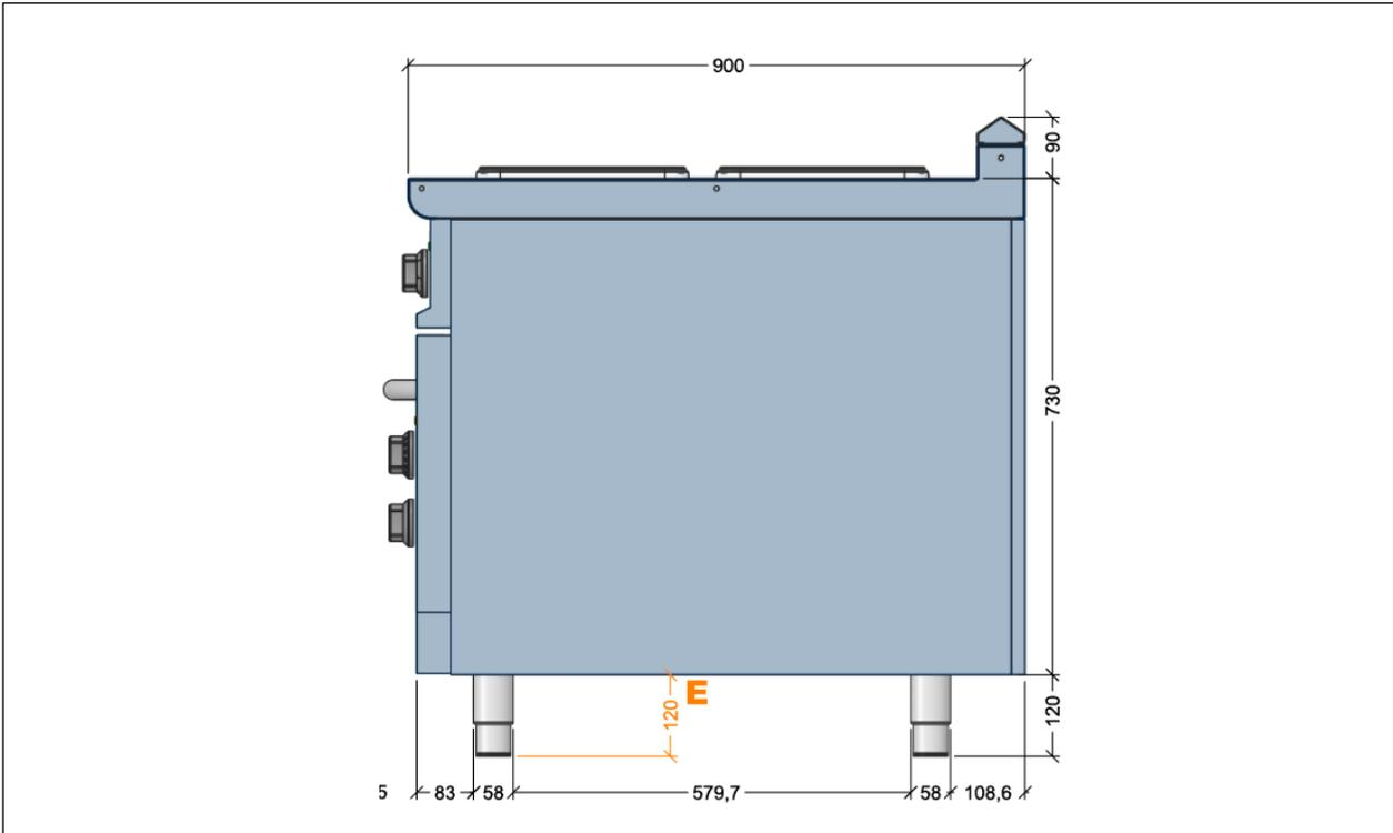
Abb. 21 Abmessungen des Herdes mit geschlossenem Unterbau oder Backofen
