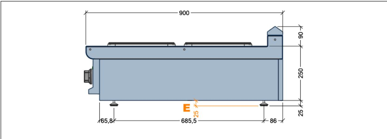
Abb. 13 Abmessungen des Tischgeräts
