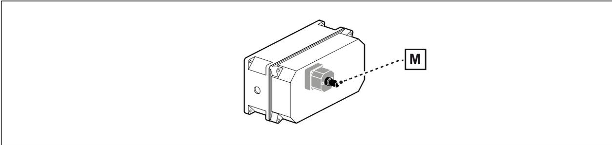
Abb. 8 Sicherheitsthermostat
