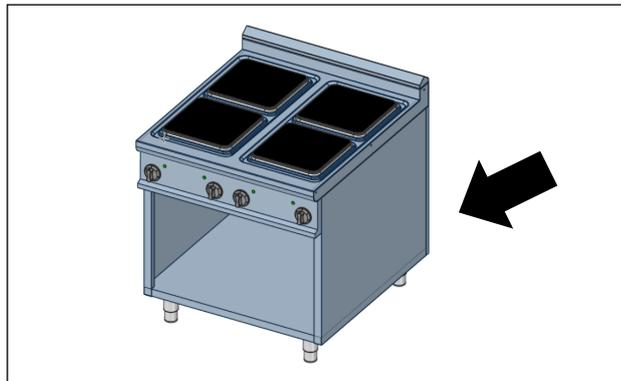
Abb. 2 Typenschildposition
