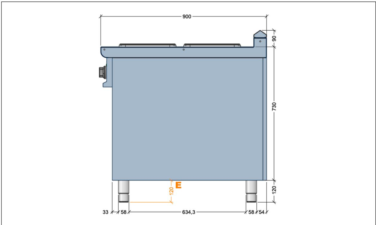
Abb. 17 Abmessungen des Herdes mit offenem Unterbau
